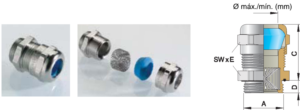
Tampa de cabo EMC folhada com níquel-latão e com rosca métrica, em conformidade com a EN50262. Proteção IP68 com até 15 bars de pressão.
